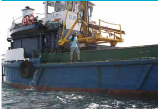
LANZADERA DE PERFORACIÓN ACOPLADA A GÁNGUIL
